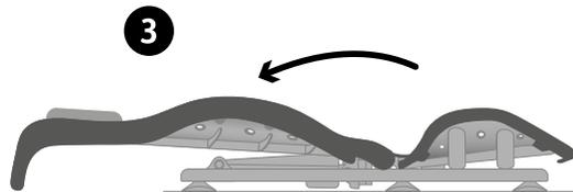
Incliner le dossier sur le Floorsitter en suivant le schéma ci-dessus.
