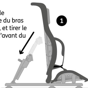
Plier le bras de levier d'inclinaison vers l'avant comme indiqué par la flèche sur le schéma ci-contre.
