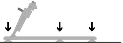
Les ventouses en caoutchouc situées sur les pieds peuvent être réglées pour faciliter leurs positionnements sur le fond d'une baignoire légèrement incurvée. Vous pouvez les ajuster en tournant les pieds dans le sens des aiguilles d'une montre ou dans le sens inverse des aiguilles d'une montre selon l'ajustement requis.
